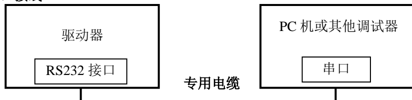
图 6 参数调试接线原理图
